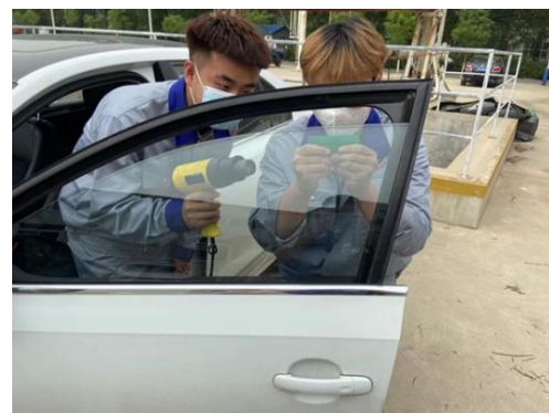
图 3：学生为车主检查发动机机舱及五液 图 4：学生为车主粘贴防爆太阳膜
